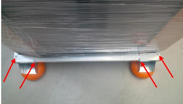
Снимите крепежные винты планок, поднимите шкаф вместе с поддоном и вытащите планки.
